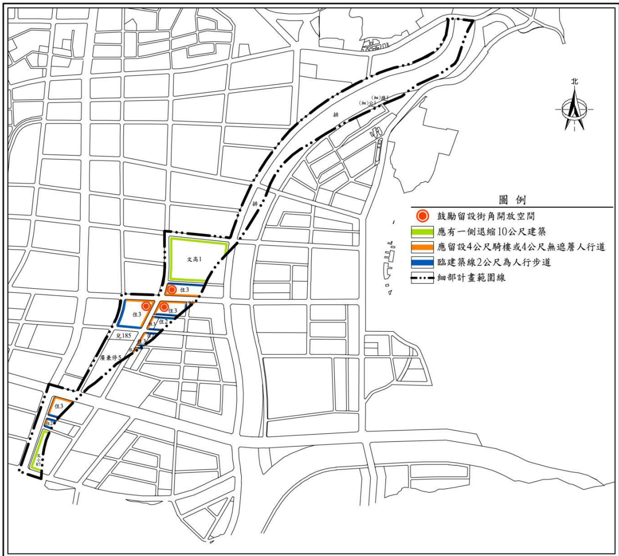
附圖 1 建築退縮、騎樓與人行道留設規定示意圖
