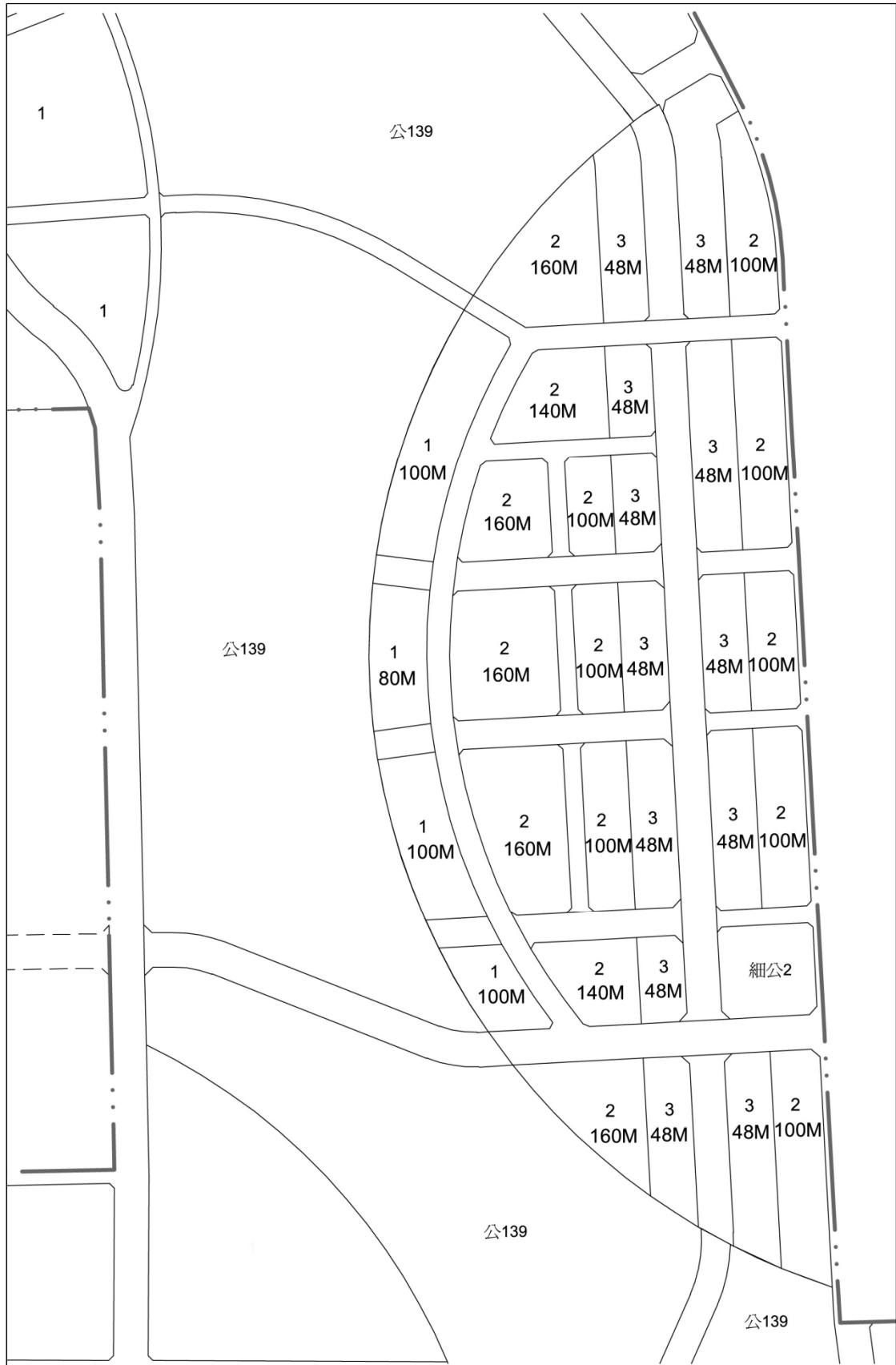
圖 6-1 各種文化商業專用區最高建築高度管制圖
